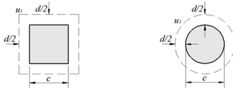
Figura 9 - Modelo para verificação da resistência à punção do ACI 318
